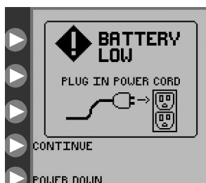
Рис. 32. Экран Battery Low. Данное сообщение свидетельствует о том, что нужно немедленно подзарядить аккумулятор.
