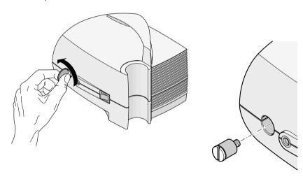
• Замените фильтр и вставьте держатель в компрессор. Поверните держатель по часовой стрелке.
