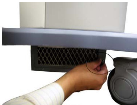
Рис. 3-9. Открутите боковой воздушный фильтр
