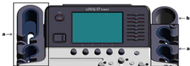
Рис. 3-6. Держатель для датчика и подогреватель (держатель) для геля
