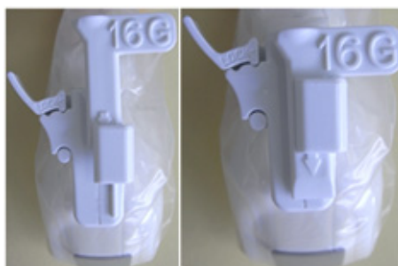
Рис. 17-23. Установка насадки для игл
