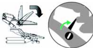
Рис. 3-25. Сложите монитор и зафиксируйте его кронштейн
