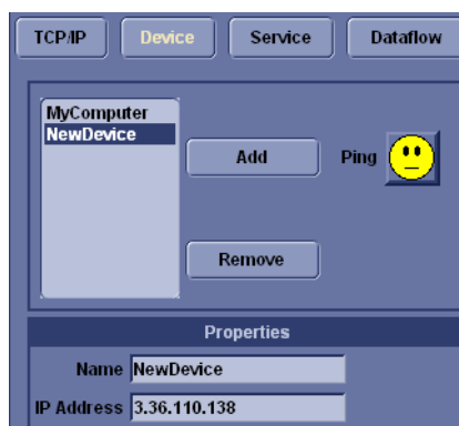
Рис. 15-19. Настройка сервиса сетевого сохранения данных: устройство
