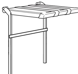
Складной столик с размерами рабочей поверхности 350x460 мм. На стойках каркаса установлена планка сечением 10x25мм для размещения дополнительного оборудования.
