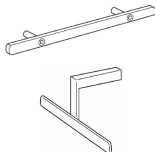
Стационарные планки сечением 10x25мм установлены в головной и ножной части панели - 2 шт
