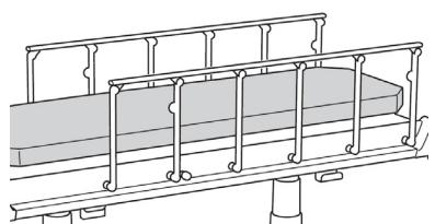
Складывающиеся ограждения длиной 1350 мм поднимаются над матрасом на 210 мм, в опущенном положении - ниже уровня матраса. Выполнены из углеродистой конструкционной стали с полимерным (порошковым) покрытием.
